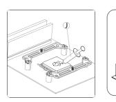
涂好导热膏,然后先锁好散热器,再固定风扇
