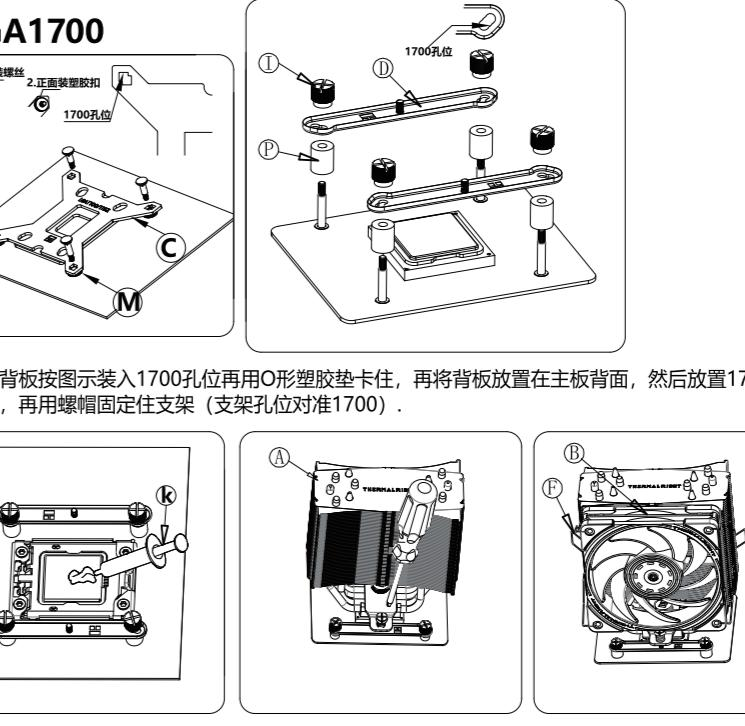
涂好导热膏，然后用螺丝刀锁好主体，再用风扇线扣固定风扇。
