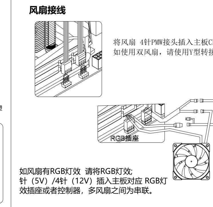
将风扇4针PMW接头插入主板CPU FAN插座
