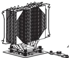
Platzieren Sie den Kühlkörper auf den Montagerahmen und sichern ihn mit der Anpressdruckjustierungsplatte, indem Sie diese mit den beiden Sechskantschrauben verschrauben. Ziehen Sie die zentrale Einstellschraube mit dem gekrüpfen Vielzahnsschlüssel bis zum gewünschten Anpressdruck an. (Über die Einstellschraube lassen sich bis zu 30 lbs Anpressdruck auf den Kühler ausüben. Jede halbe Umdrehung erhöht den Druck um 10 lbs, maximal bis zu 70 lbs.)
