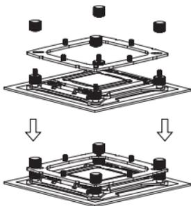
Setzen Sie den Montagerahmen auf die vier LGA2011 Typ C Adapterschrauben. Anschließend fixieren Sie die vier LGA2011 Typ C Adapterschrauben mit den Rändelmuttern.
