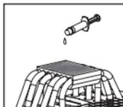
Tragen Sie eine hauchdünne Schicht Wärmeleitpaste auf der Oberfläche der CPU und auf der Unterseite des Kühlers auf.
