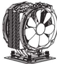
Verbinden Sie die beiden TY-141 Lüfter mit dem PWM Y-Kabel und schließen Sie das Kabel nun an den CPU PWM Lüfteranschluss auf dem Mainboard an. Die Installation ist abgeschlossen.
