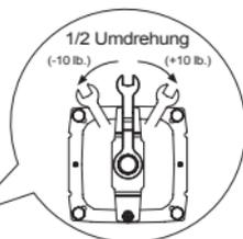
Platzieren Sie den Kühlkörper auf den Montagerahmen und sichern ihn mit der Anpressdruckjustierungsplatte, indem Sie diese mit den beiden Sechskantschrauben verschrauben. Ziehen Sie die zentrale Einstellschraube mit dem gekröpften Vielzahn Schlüssel bis zum gewünschten Anpressdruck an. (Über die Einstellschraube lassen sich bis zu 30 lbs Anpressdruck auf den Kühler ausüben. Jede halbe Umdrehung erhöht den Druck um 10 lbs, maximal bis zu 70 lbs.)
