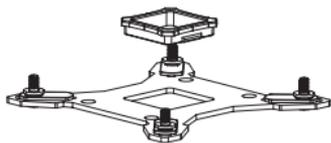
Bei Verwendung einer Intel Socket 775 Plattform setzen Sie zuerst den Backplate Aufsatz in die quadratische Öffnung der Backplate ein. Gehen Sie sicher, dass der Aufsatz nach unten zeigt.
