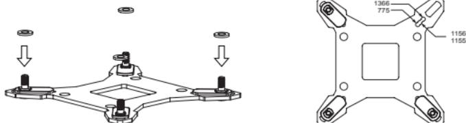
Achten Sie auf die für Ihr System entsprechende vorgesehene Bohrungen (Intel Socket 775/1155/1156/1366) in der Multi Plattform Backplate. Führen Sie die vier Schraubenzylinder jeweils von unten durch diese Bohrungen. Legen Sie die vier Unterlegscheiben (für Intel) über die hervorstehenden Gewinde.
