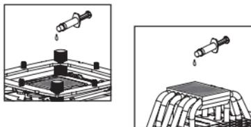
Tragen Sie eine hauchdünne Schicht Wärmeleitpaste auf der Oberfläche der CPU und auf der Unterseite des Kühlers auf.
