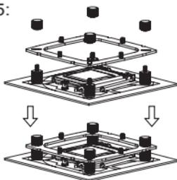
Setzen Sie den Montagerahmen auf die vier Schraubenzylinder. Verwenden Sie die vier Rändelmutter, um den Montagerahmen auf den Adapterschrauben zu befestigen.
