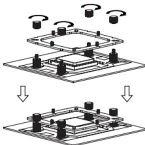
Setzen Sie den Montagerahmen auf die vier Schraubenzylinder. Verwenden Sie die vier Rändelmuttern, um den Montagerahmen auf den Adapterschrauben zu befestigen.
