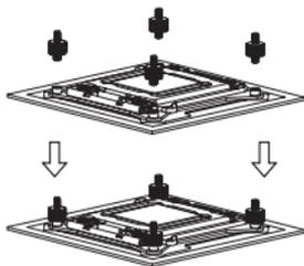
Schrauben Sie die vier LGA2011 Typ C Adapterschrauben in die Gewindebolzen auf dem Intel ILM Montagerahmen, der sich um den Prozessorsockel befindet.
