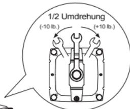
Platzieren Sie den Kühlkörper auf den Montagerahmen und sichern ihn mit der Anpressdruckjustierungsplatte, indem Sie diese mit den beiden Sechskantschrauben verschrauben. Ziehen Sie die zentrale Einstellschraube mit dem gekröpften Vielzahn Schlüssel bis zum gewünschten Anpressdruck an. (Über die Einstellschraube lassen sich bis zu 30 lbs Anpressdruck auf den Kühler ausüben. Jede halbe Umdrehung erhöht den Druck um 10 lbs, maximal bis zu 70 lbs.)
