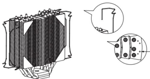
Bringen Sie die vier selbstklebenden Anti-Vibrationspads an den Ecken des Kühlkörpers an. Danach führen Sie zuerst das untere Ende der Lüfterklammer in das äußere Loch an der Lamellenunterseite (siehe Abbildung). Wiederholen Sie anschließend den Vorgang an der Oberseite.
