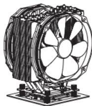
Verbinden Sie die beiden TY-141 Lüfter mit den PWM Y-Kabel und schließen Sie das Kabel nun an den CPU PWM Lüfteranschluss auf dem Mainboard an. Die Installation ist abgeschlossen.
