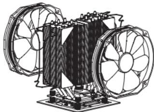
Positionieren Sie die beiden TY 141 Lüfter auf dem Kühlkörper und befestigen Sie diese mit den Lüfterklammern, indem Sie die Ecken paarweise in die vier Montagelöcher ziehen.
