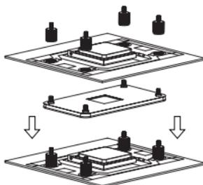
Nehmen Sie die Backplate für Ihr AMD System. Legen Sie diese von unten an Ihr Mainboard an, so dass die Gewindebolzen durch die Befestigungslöcher des Mainboards gehen. Schrauben Sie nun die Adapterschrauben von oben in die Gewindebolzen.
