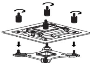
Platzieren Sie das Mainboard von oben auf die Backplate, so dass die hervorstehenden Schraubengewinde durch die Löcher um den Prozessorsockel gehen. Schrauben Sie die beiliegenden Rändelschrauben auf die vier Schraubengewinde.
