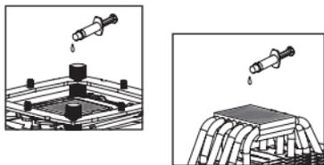
Step 6 : Applying Thermal Paste
